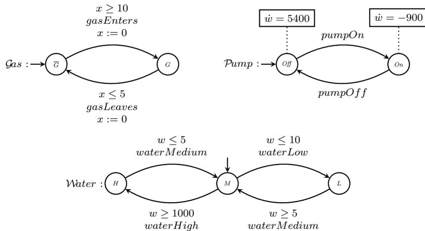
2. L'idée générale derrière le contrôleur est qu'il recevra des messages venant de  $Gas$  et  $Water$  et enverra des messages à  $Pump$ . Il n'a pas besoin de reprendre les gardes déjà implémentées par les sous systèmes de la question précédente. Le contrôleur appliquera la stratégie suivante :
